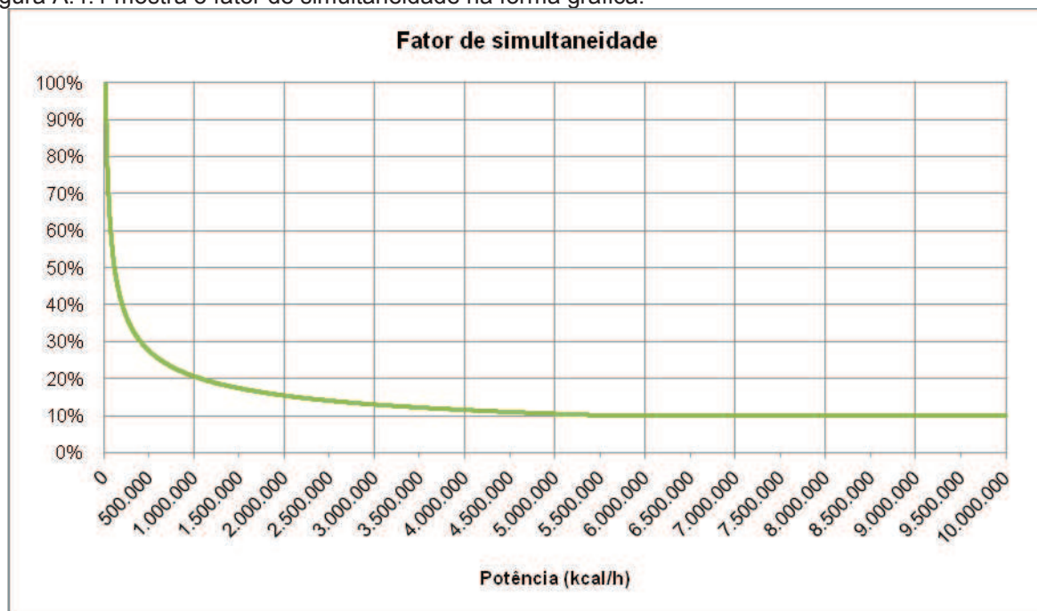
Figura A.4.1 - Curva do fator de simultaneidade – potência
