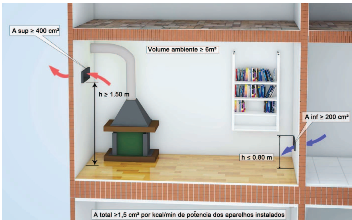
Figura 7.31 - Exemplo ilustrativo de instalação de lareira
